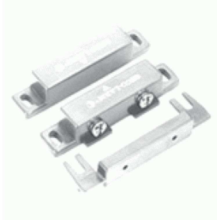
Este tipo de contacto es para (N / C) circuitos normalmente cerrados lo que significa que cuando los imanes se alinean, se cierra el interruptor. Este tipo de configuración es ideal para controlar puertas, ventanas y puertas corredizas. Midiendo 2.48 pulgadas de largo y 1/2 pulgadas de alto, los contactos se unen con tornillos de metal de madera o de chapa (no incluido) para el marco de la puerta o ventana,
